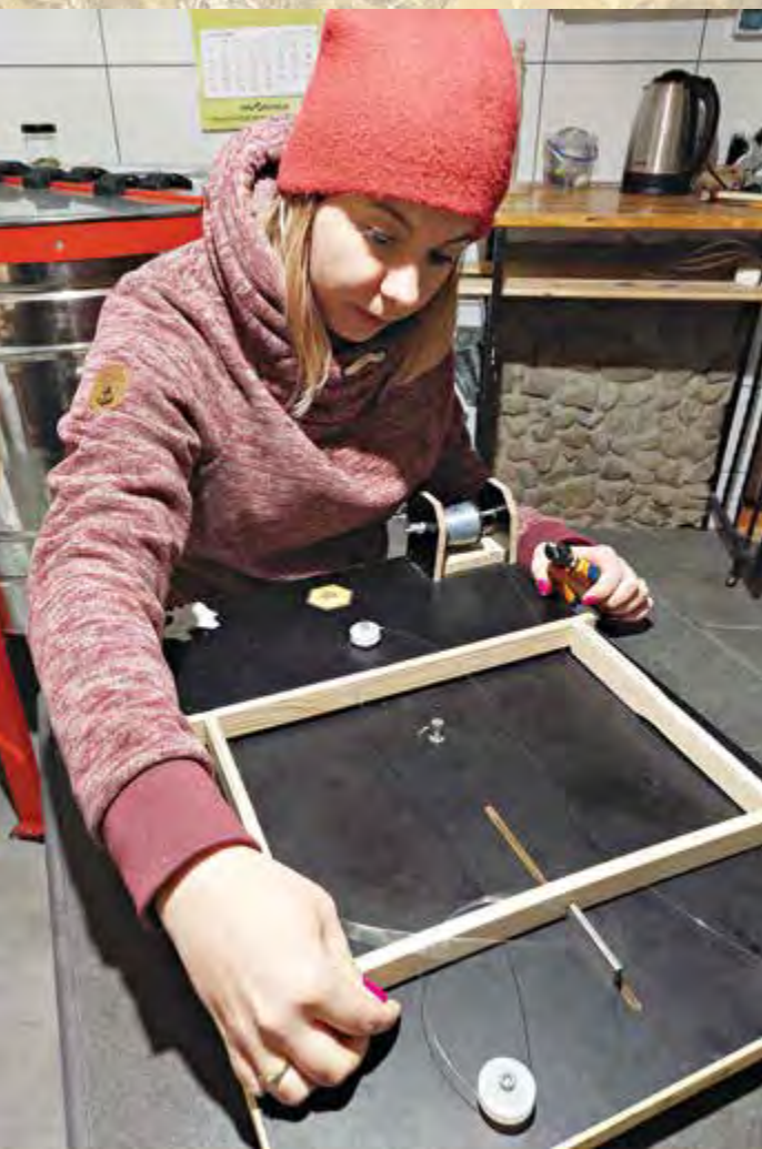
Sprawne ręce przewlekają drut przez otwory w ramce
