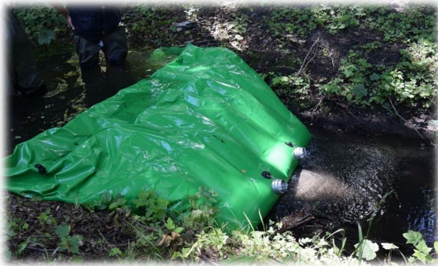
Wielofunkcyjny przenośny próg piętrzący (Fot. K. Krężałek)
